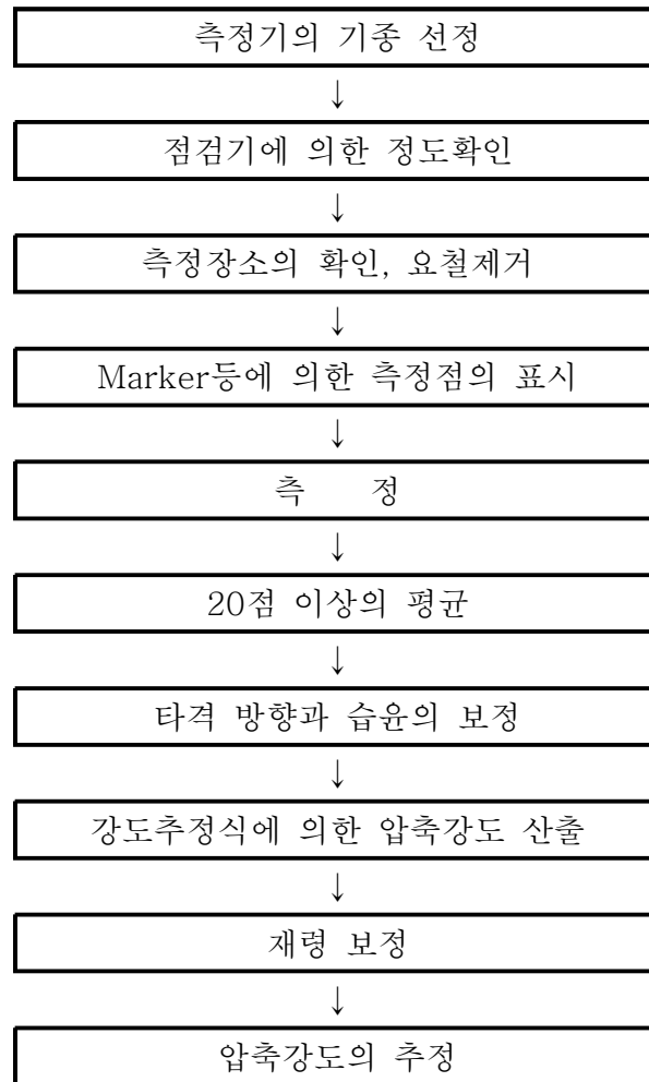
<그림 2.1> 반발경도법에 의한 압축강도 추정도
